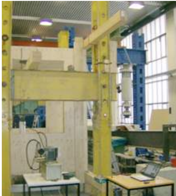
Versuchsaufbau Belastungsprüfung Balkon
