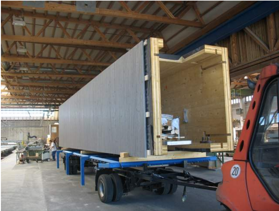
Vorgefertigter Aufzugschacht im Werk
