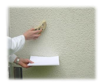
Abgefegte Menge pro m<sup>2</sup>: unter 50 g >> 400 Jahre Lebensdauer bei 20 kg/m<sup>2</sup> Auftragsmenge
