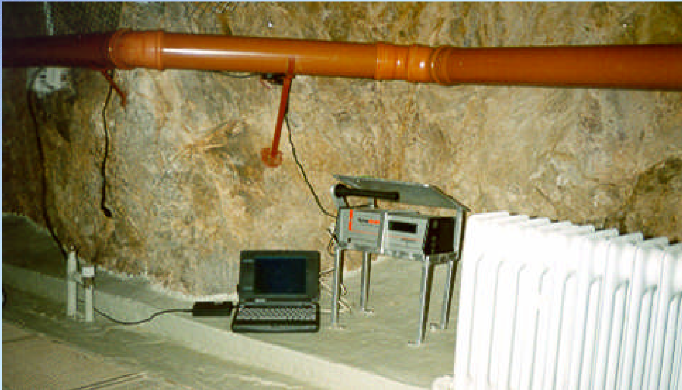
Kontinuierliche Langzeiterfassung der Radonkonzentration in einem Heilstollen (AlphaGUARD im Diffusionsbetrieb)
