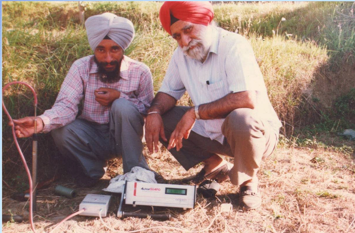
Bodenluftprobennahme mit AlphaGUARD, AlphaPUMP und Bodenluftsonde
