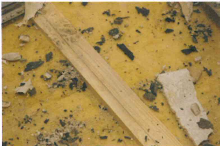
Bild 3: Zustand der Holzbauteile nach Abschluss der Brandprüfung einer brandschutztechnisch wirksamen Bekleidung nach DIN EN 14135 zur Klassifizierung K 2 60 nach DIN EN 13501-2
