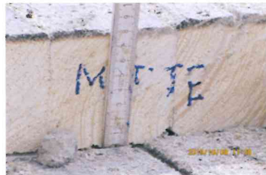
Bild 9: Prüfung einer tragenden, raumabschließenden Massivholzwand REI-M 90 mit einer K 260 -Brandschutzbekleidung
