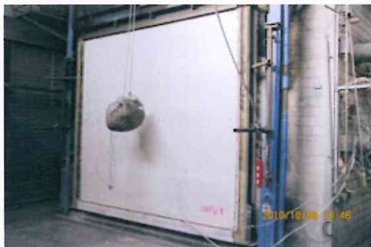
Bild 9: Prüfung einer tragenden, raumabschließenden Massivholzwand REI-M 90 mit einer K 260 -Brandschutzbekleidung
