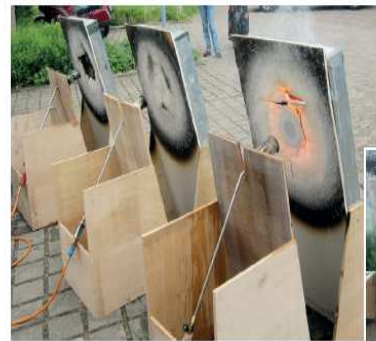
Brandtest: climacell® Cellulosedämmung im Vergleich zu Polystyrol und Steinwolle.
