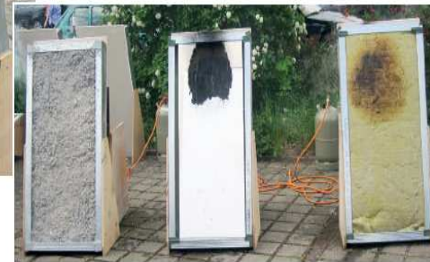
Brandtest: climacell® Cellulosedämmung im Vergleich zu Polystyrol und Steinwolle.
