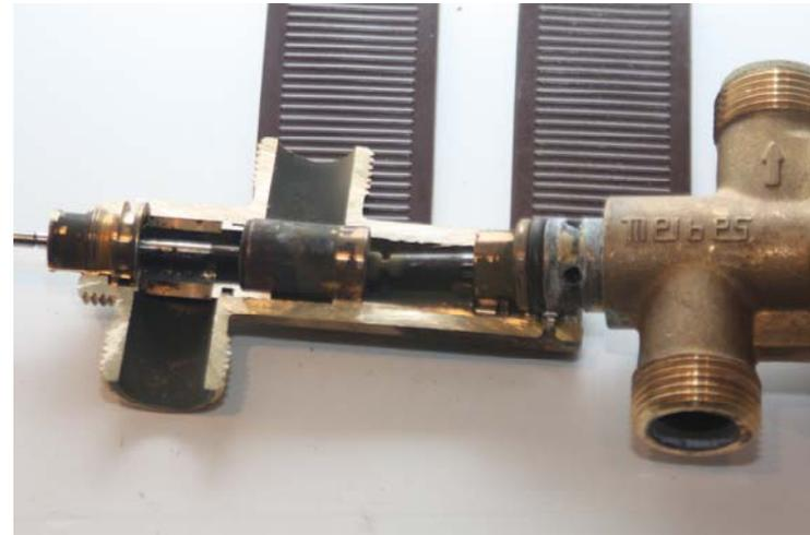
**FOLGE:** „...>Wasserschaden< durch Ablagerungen & deformierte O-Ringe“
