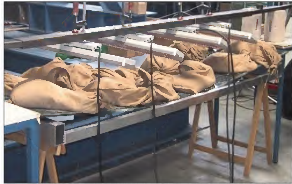
Resttragfähigkeitstest eines 10mm PV Moduls
