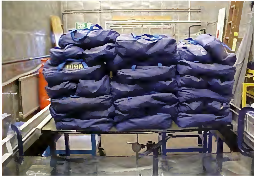
Test einer 10+8 VSG Scheibe
