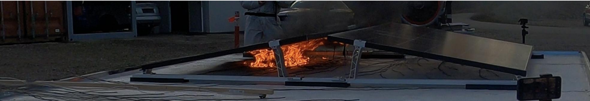
t = 5:03 min, Wärmestau unter Modul
