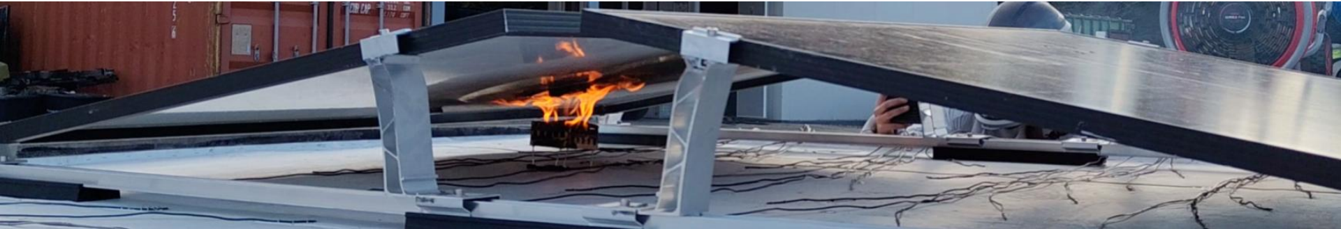
t = 5:03 min, Wärmestau unter Modul
