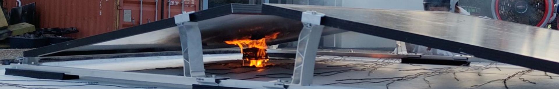
t = 8:06 min, Selbstständiges Mitbrennen der Dachhaut
