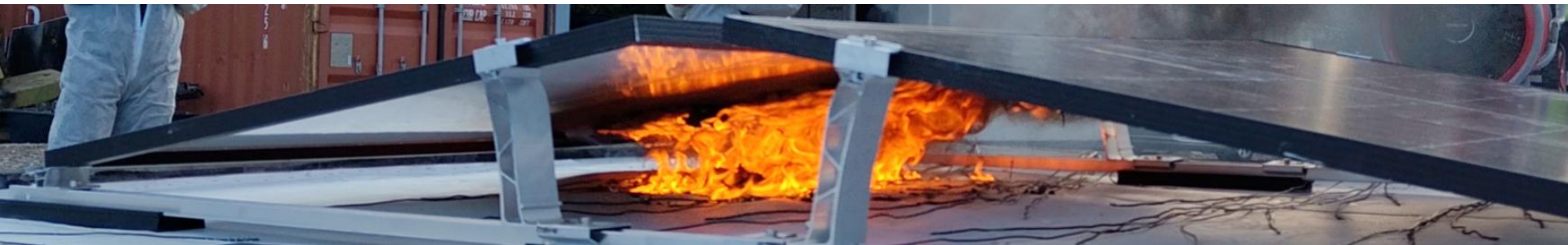
t = 8:06 min, Selbstständiges Mitbrennen der Dachhaut
