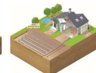
Erdgekoppelte Wärmepumpe: Erdwärmekollektor möglich
