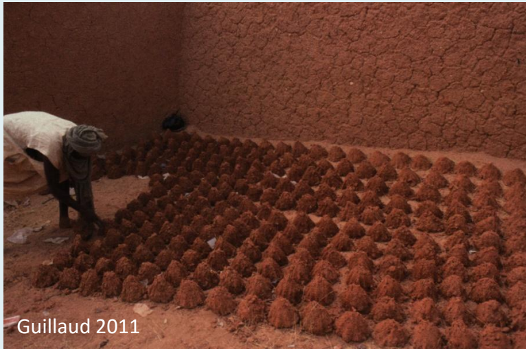
Produktion sogen. „tubali“ im Norden Nigerias
