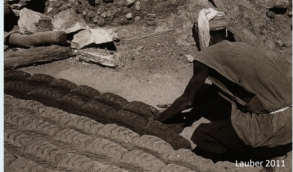
Herstellung von „gekrümmten“ Ziegeln. Dogon, Mali
