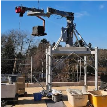
Spezielle Zange für Mauerkran (Stein-Rex Minikran)
