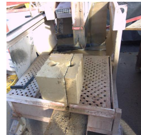
Säge hier: Säge statisch, Stein bewegt sich -> besser umgekehrt, Schneiden der Steine mit Wasser unzulässig => massive Staubentwicklung
