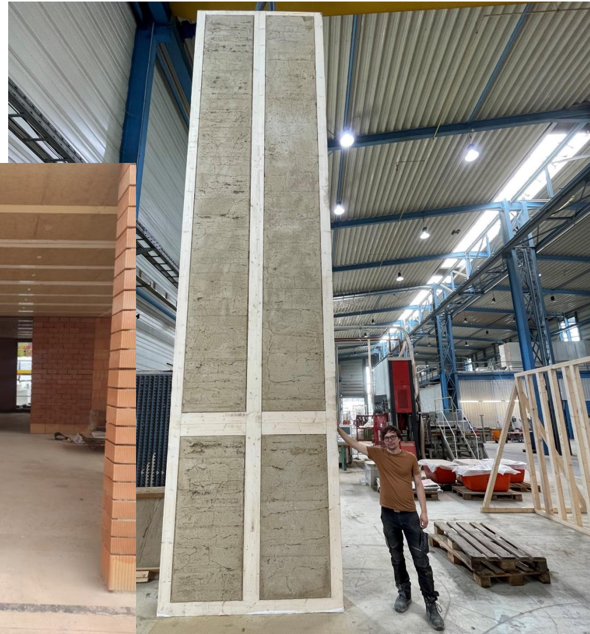
Holz-Lehm-Massivdecke mit Fließlehm im Werk hergestellt
