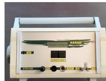
RTM 1688-2, Innenräume, Radon Sniffing, Bodenluft
