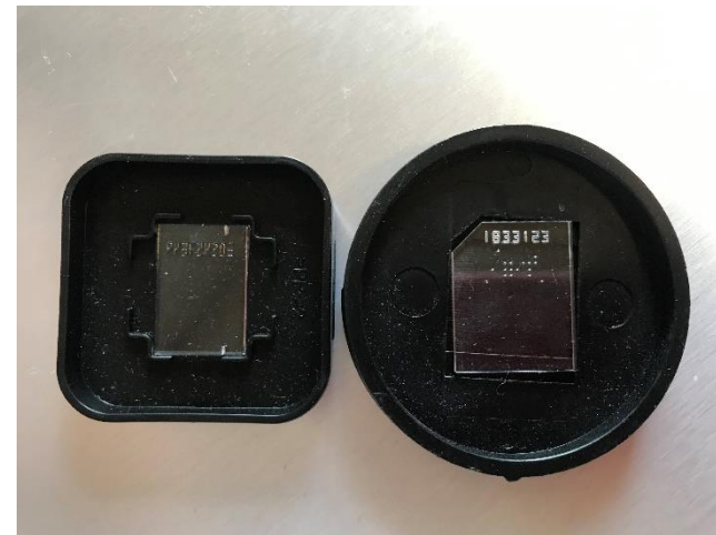
Geöffneter Radon-Detektor, Detektorfläche, Auswertung im Labor
