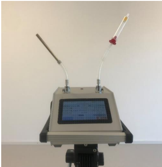
Luftprobensammler BiVOC2V2 (Holbach Messtechnik) mit Medien. Links: Tenax-Röhren, rechts: DNPH-Kartusche
