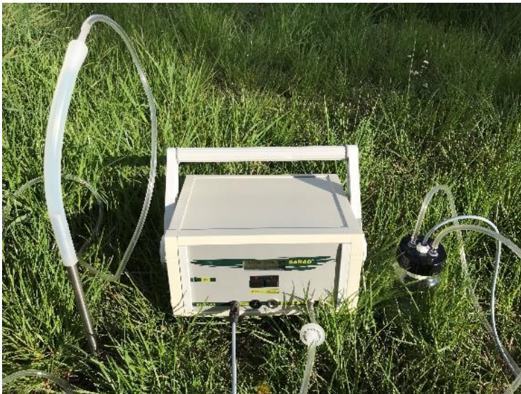
Messgerät RTM 1688-2 mit Bodenluftsonde und Wassereintrittsschutzflasche
