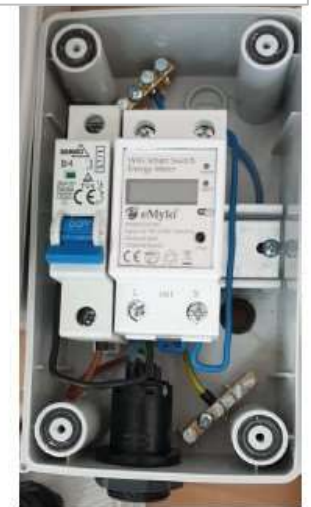
Anschlussbox innen (vorverdrahtet)
