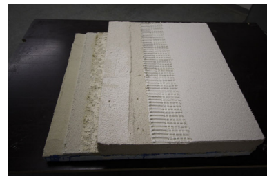
Musterplatte mit Schaummörtel und Leichtputzmörtelproben
