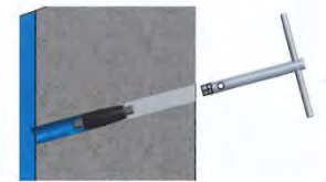
Verschließen des Bohrlochs mit Blindpacker Obturation of bore hole with blind packer
