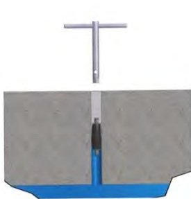
Verschließen des Bohrlochs mit Blindpacker Obturation of drill hole with blind packer
