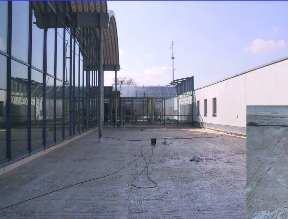
Tracer-Gas Methode auf trockenem Foliendach
