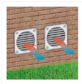
2-Schlauch-Technik ersetzt Außenteil
