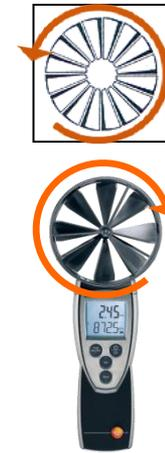
Eine zu **niedrige** Strömungsgeschwindigkeit wird angezeigt.
