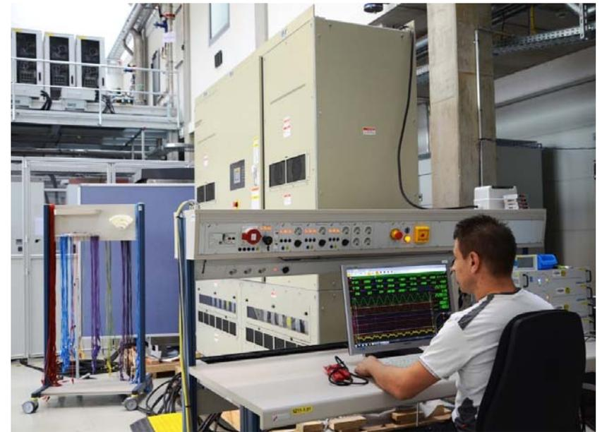
Prüfung eines Solarwechselrichters mit 2,5 Megawatt Leistung im TestLab Power Electronics des Fraunhofer ISE.
